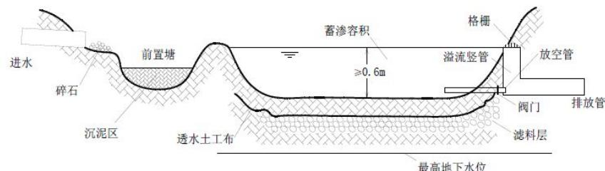
图 8.5.1 (4) -1 渗透塘典型构造示意图
