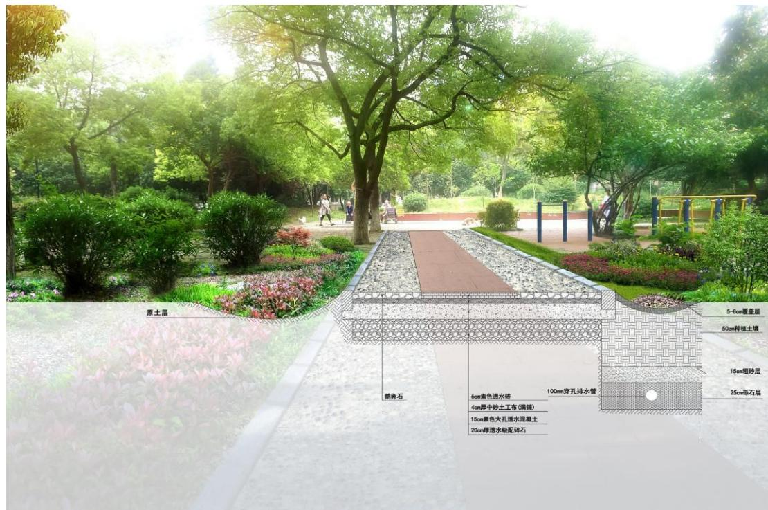
图8.5.4(1)-1透水铺装及两侧植草沟实景图(一)
