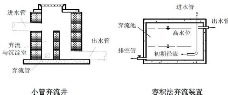
图 8.5.3 (2) 初期雨水弃流设施示意图
