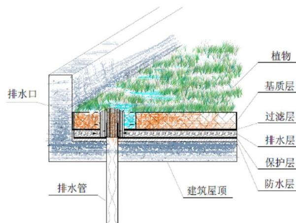
图 8.5.1 (2) -1 绿色屋顶典型构造示意图
